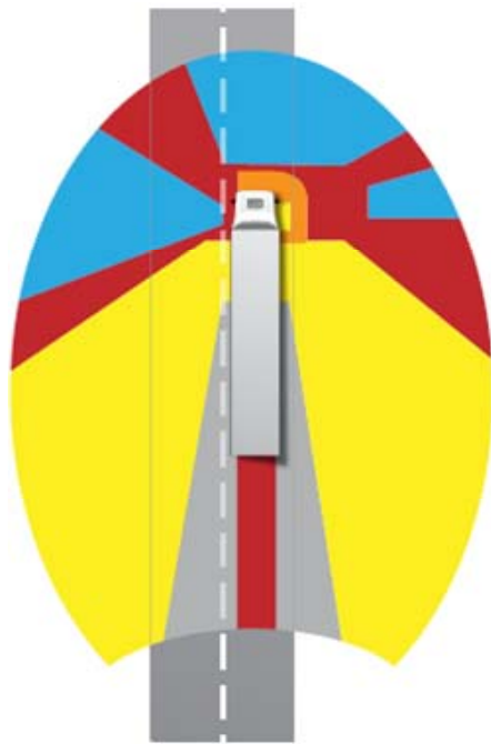
Figuur 4 Weergave van de dode hoeken rond een vrachtwagen
