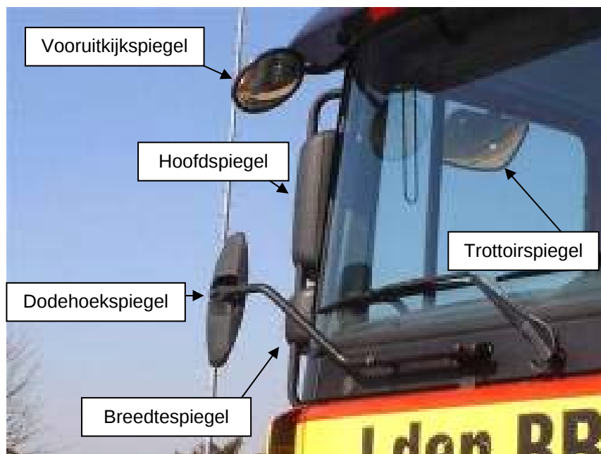
Figuur 5 De spiegels aan de rechtervoorkant van de vrachtwagen
